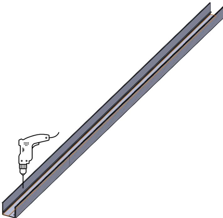
Fissare il profilo compensatore a terra utilizzando i 2 fori di servizio diametro 5mm. In presenza di vetrata con impacchettamento da entrambi i lati, i fori di servizio non vengono eseguiti, ma possono essere direttamente utilizzati quelli di fissaggio standard da 8 mm. Forare in corrispondenza dei fori di fissaggio guida diametro 8 mm ed inserire il tassello.
