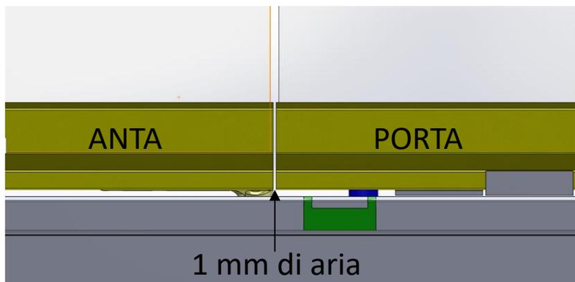
A seguito dell'inserimento della porta, si deve regolare il finecorsa dell'anta finale.
