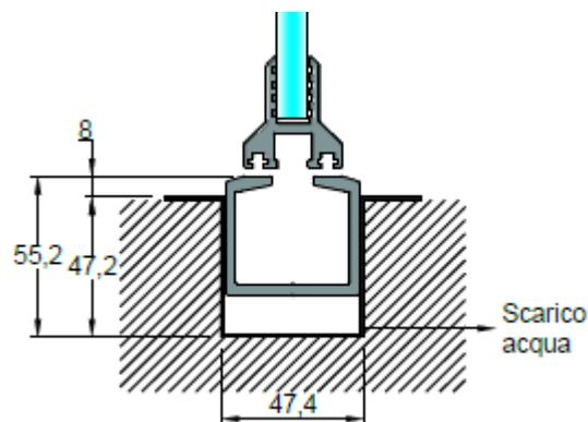
Nel caso di guida incassata le fasi di installazione sono le stesse della guida fuori terra.
