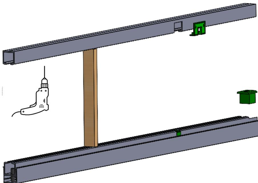
Facendo particolare attenzione al piombo verticale dei binari superiore ed inferiore, forare e fissare la guida superiore. Ove necessario spessorare tra il binario e la superficie di fissaggio. Per comodità, forniamo una dima in legno che determina la distanza tra binari superiore e inferiore. Smontare il tappo uscita superiore ed il cubotto porta inferiore (colore verde) per preparare il lavoro all'inserimento delle ante.
