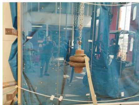
Campione durante la prova d'impatto
