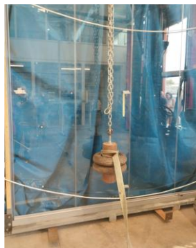
Campione durante la prova d'impatto
