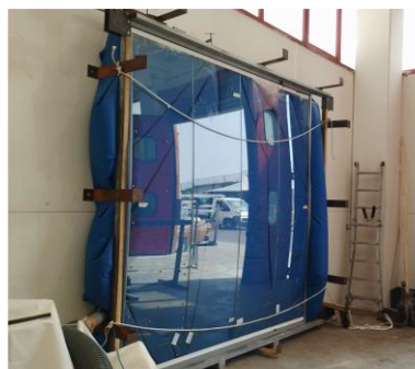
Campione durante la prova al vento
